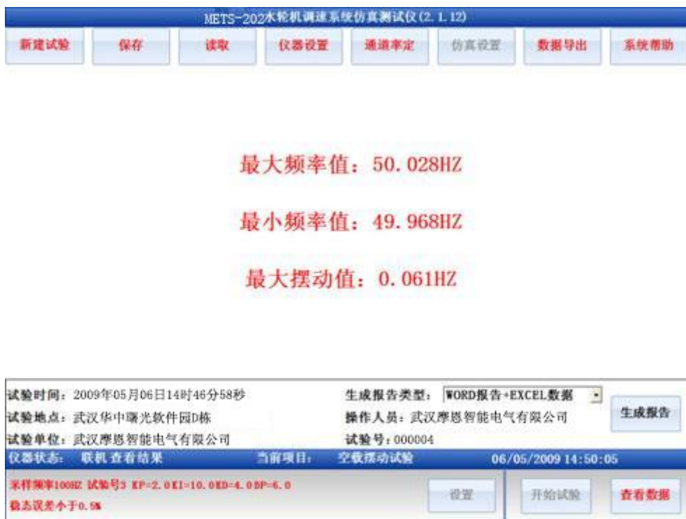
图 3.8 空载摆动试验结果
